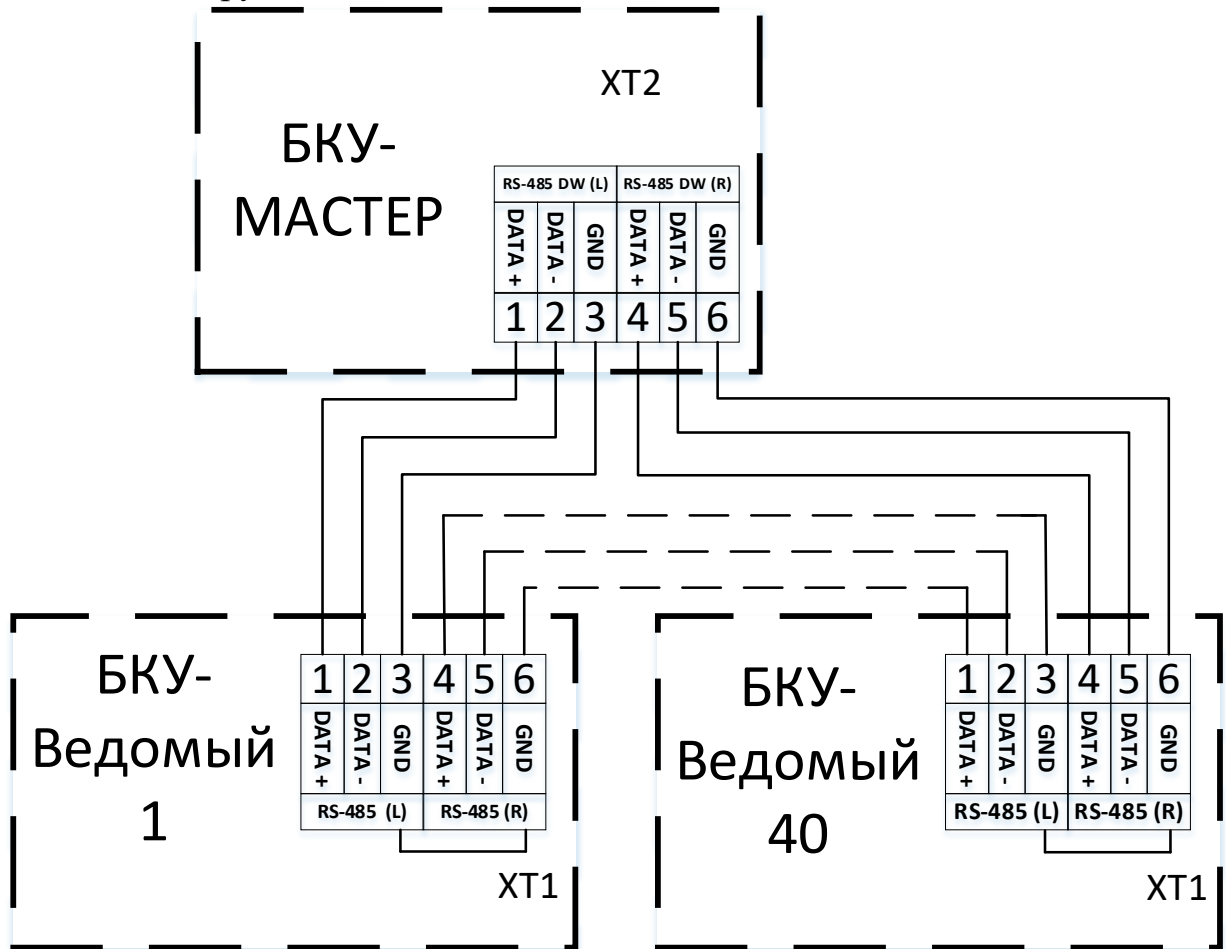
Рисунок 20 – Подключение ведомых БКУ-И к главному БКУ-И–Мастер.
